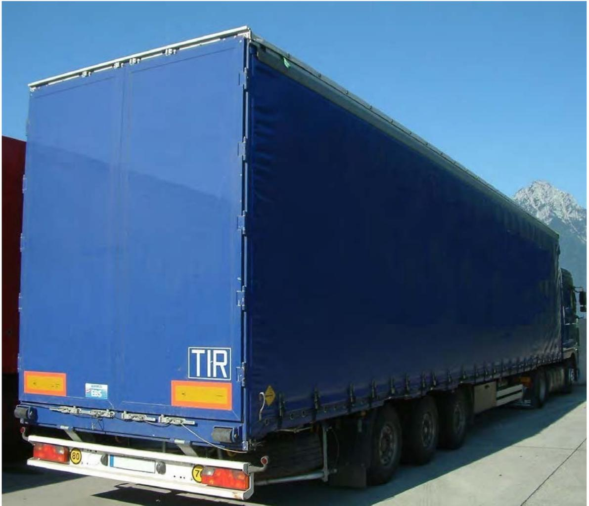
Bild VI/1: Schiebeplanenaufbau
