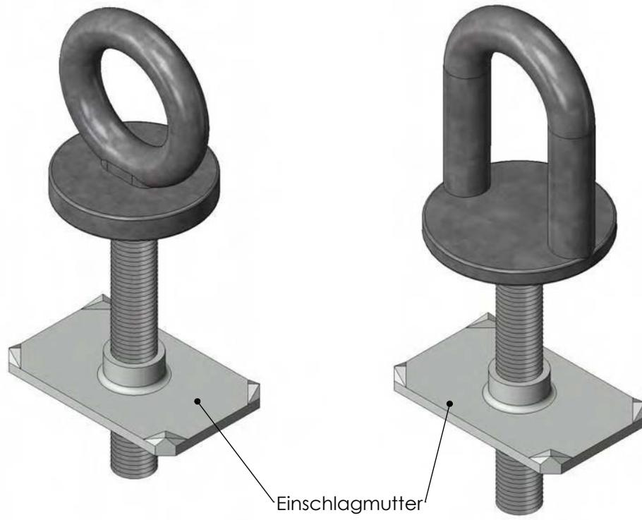
Bild V/23: Ringschrauben
