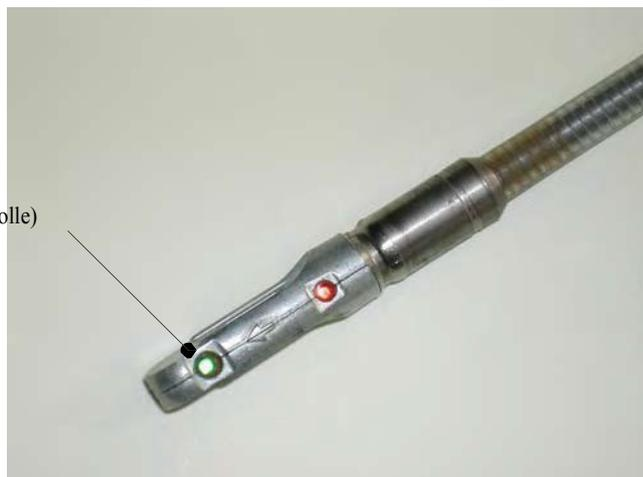
Bild V/14: Seil aus gebündelten, mit Spiraldraht ummantelten Glasfaserbändern
