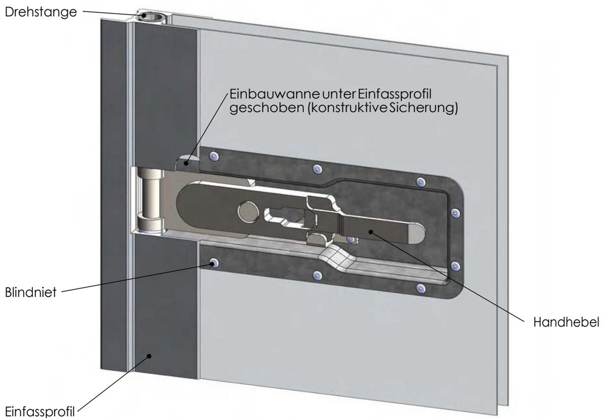
Bild III/51: Konstruktive Sicherung
