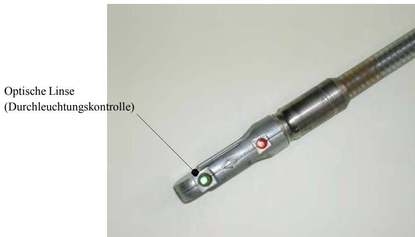
Bild IV/28: Seil aus gebündelten, mit Spiraldraht ummantelten Glasfaserbändern
